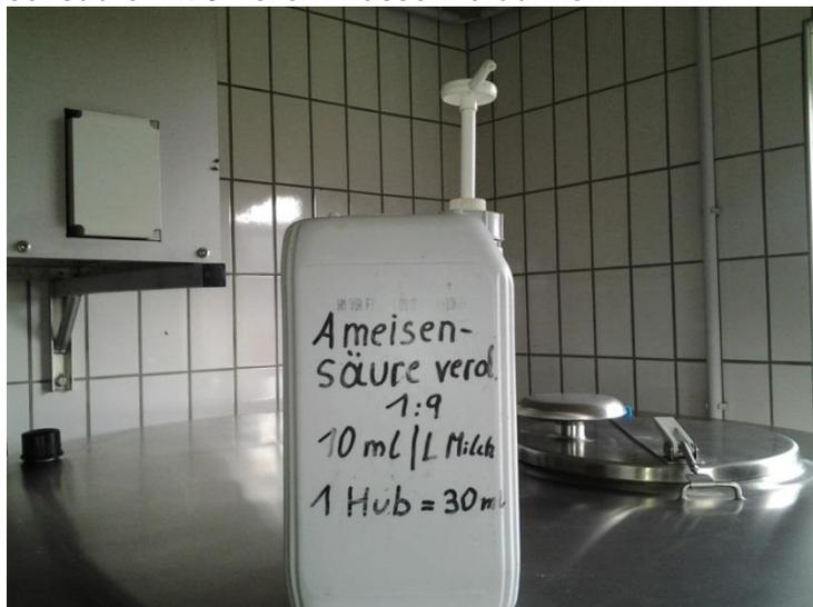
2. Verdünnte Säure mit Pumpe dosieren
